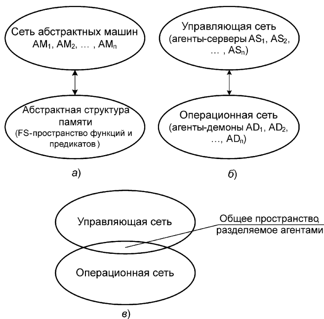
Рис. 1. Логическая (а), физическая (б) и интегрированная физическая (в) структуры сети хранения и обработки данных
