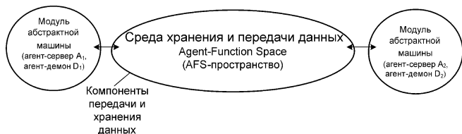
Рис. 4. Реализация межмодульных причинно-следственных связей через интегрированное AFS-пространство
