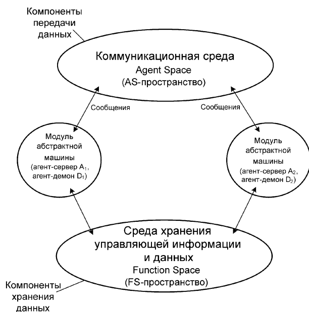
Рис. 3. Реализация межмодульных причинно-следственных связей через разделенные AS- и FS-пространства
