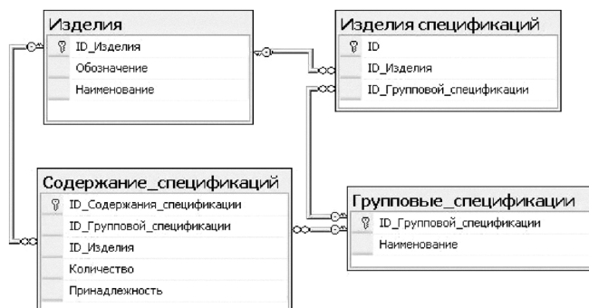
Рис. 3. ER-модель базы данных групповых спецификаций с полем принадлежности
