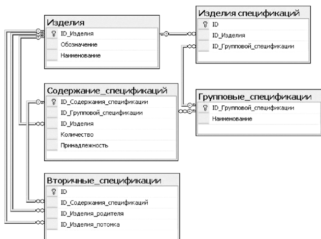
Рис. 4. ER-модель базы данных групповых спецификаций с полем принадлежности и вторичной спецификацией
