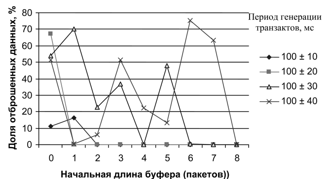
Рис. 2. Зависимость потерь аудиоинформации от начальной длины буфера
