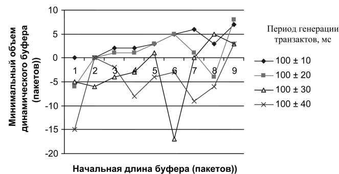
Рис. 3. Зависимость минимального объема динамического буфера от начальной длины буфера
