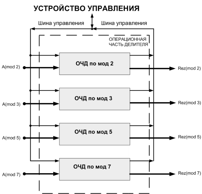
Рис. 5. Операционная часть устройства деления — Блок А и Блок В
