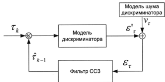
Рис. 3. Модель ССЗ при линейной аппроксимации сигнала на выходе дискриминатора
