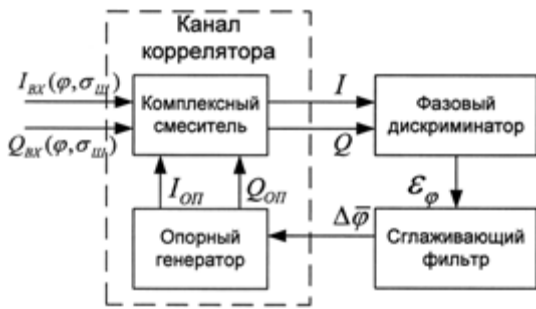
Рис. 4. Структура неоптимизированной модели схемы слежения за фазой сигнала
