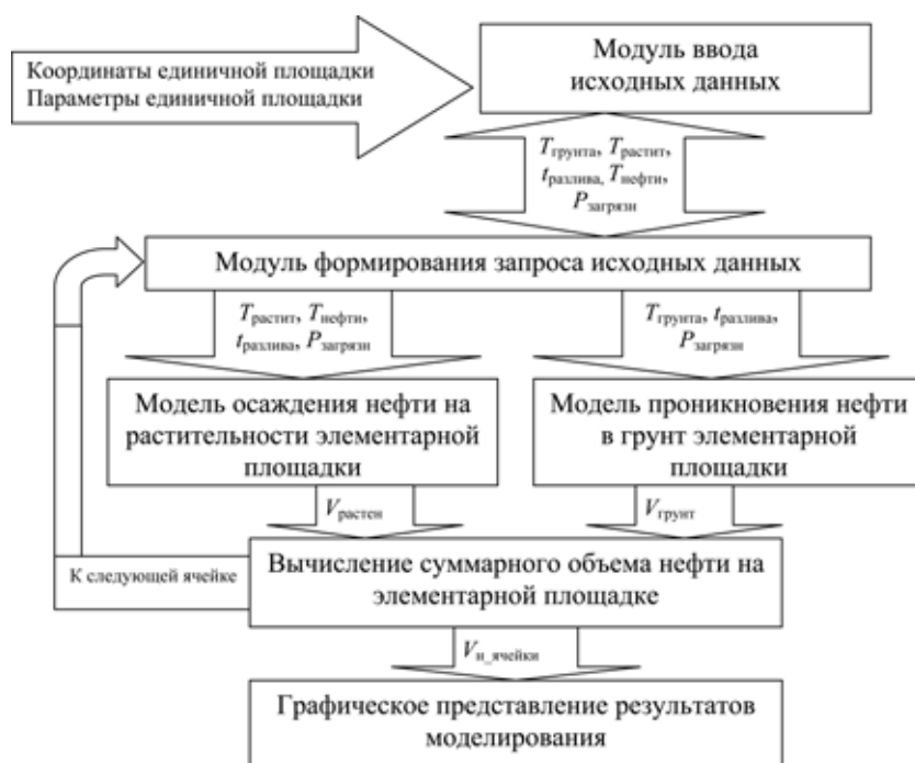
Схема комплексной модели осаждения нефтяных загрязнений на береговую поверхность
