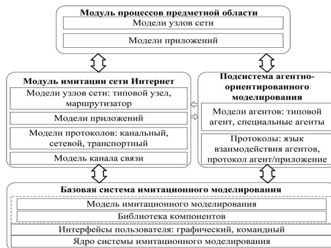
Рис.2. Архитектура системы моделирования
