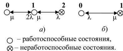
Рис. 3. Граф переходов для дублированного узла: а — для узла в полном составе;  $\lambda$  — интенсивность отказов узла;  $\mu$  — интенсивность восстановления узла; б — для узла в состоянии технического обслуживания
