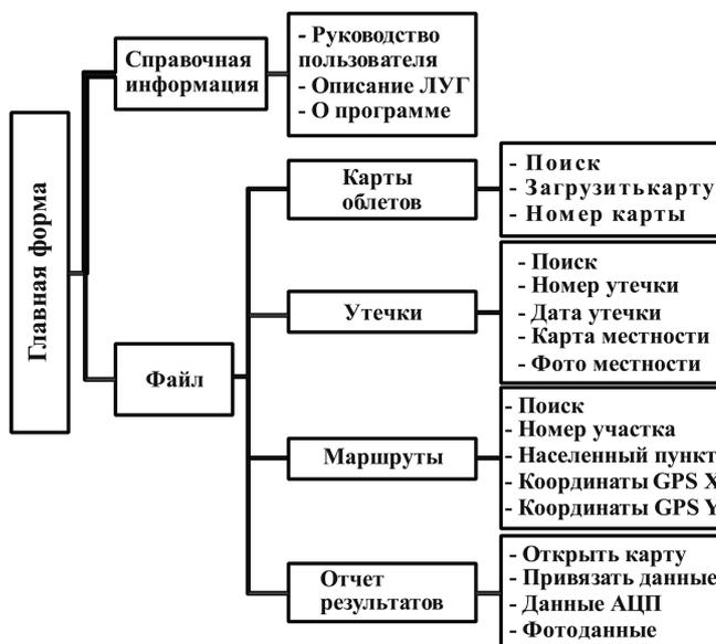
Рис. 3. Структурная схема интерфейса "АРМ оператора ЛУГ"
