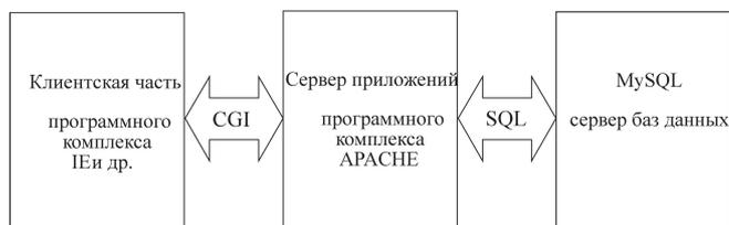
Рис. 2. Трехуровневая архитектура "клиент-сервер"
