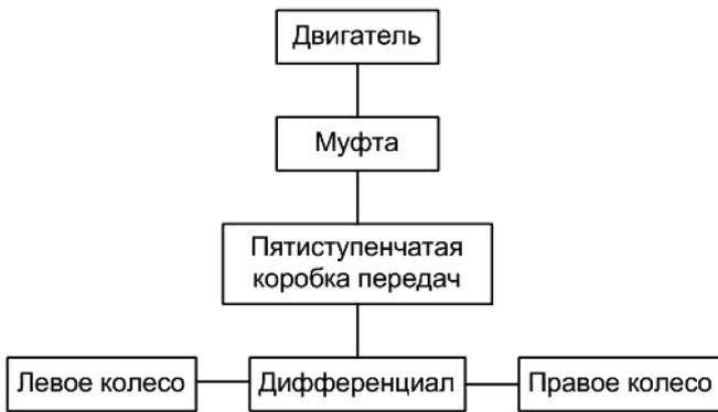
Рис. 1. Структурная схема модели
