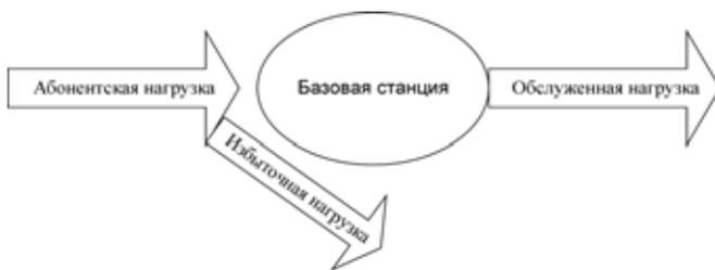
Рис. 1. Нагрузки на базовой станции
