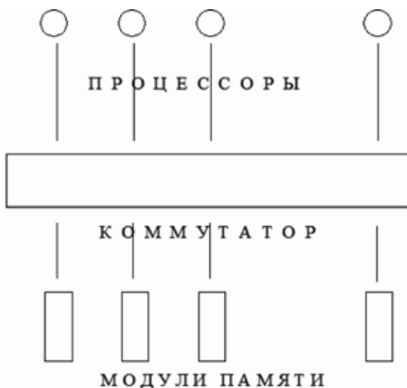
Рис. 2. Многопроцессорная система с общей распределенной памятью
