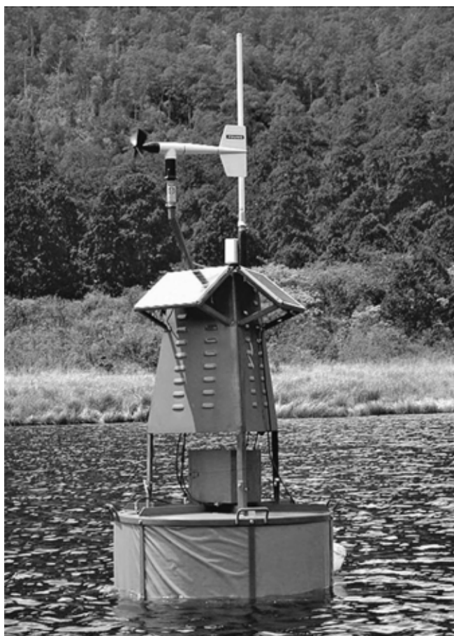
Рис. 4. Беспроводной буй на озере Юан Янг, Тайвань. Питается от солнечных батарей [3]
