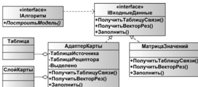
Рис. 3. Применение паттерна проектирования Адаптер
