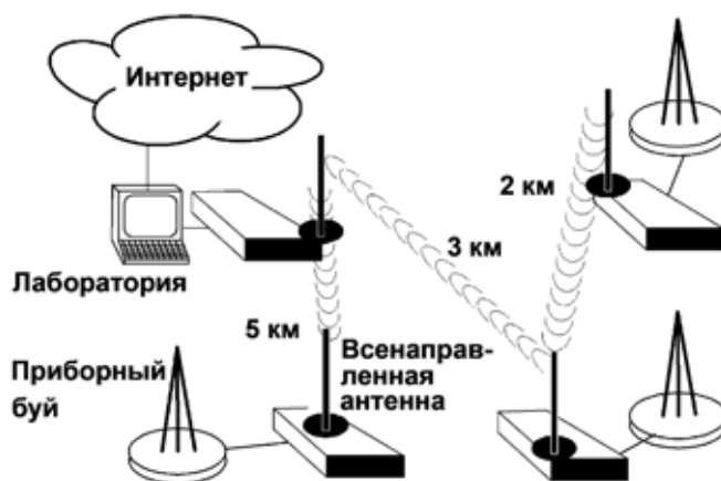
Рис. 5. Схема аппаратуры для беспроводной сенсорной сети. Для соединения последовательно опрашиваемых приборных буй с лабораторией используется цифровая радиосвязь с распределенным спектром. Скорость — 0,115 Мбит/с, частота — 900 МГц [3]
