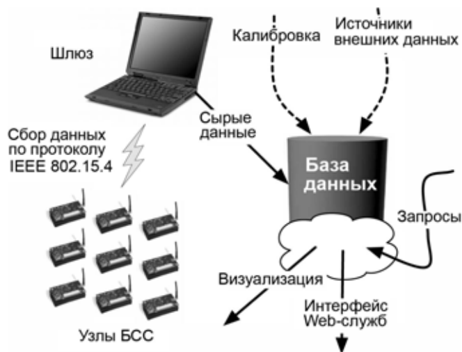
Рис. 1. Архитектура системы сбора данных [2]
