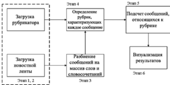
Рис. 2. Структурная схема процесса контент-анализа RSS-сообщений
