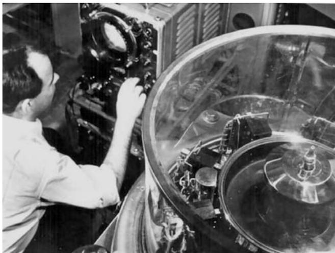
Рис. 2. Гёза Ковач возле магнитного барабана М-3
