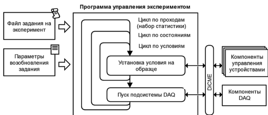
Рис. 5. Схема работы программы управления экспериментом
