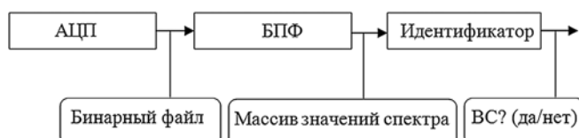
Рис. 3. Схема работы программной части системы обнаружения ВС
