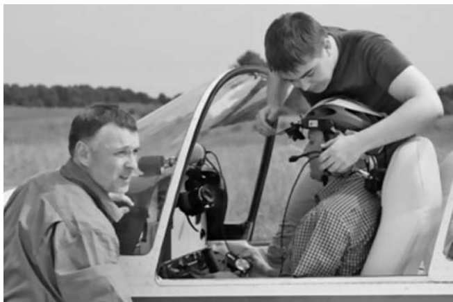
Рис. 10. Фиксация мобильной системы видеорегистрации движений глаз SMI iView X HED на голове пилота
