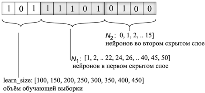
Рис. 6. Хромосома, использованная для поиска топологии ИНС
