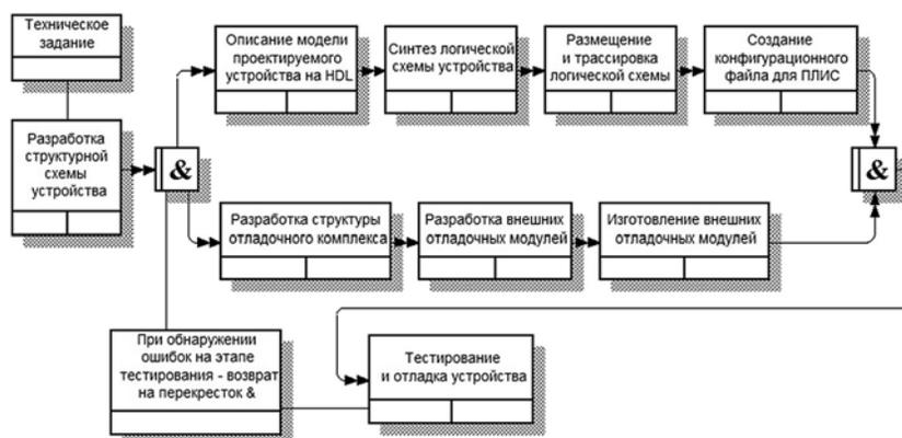
**Рис. 6. Алгоритм проектирования устройства защищенного обмена информацией**
