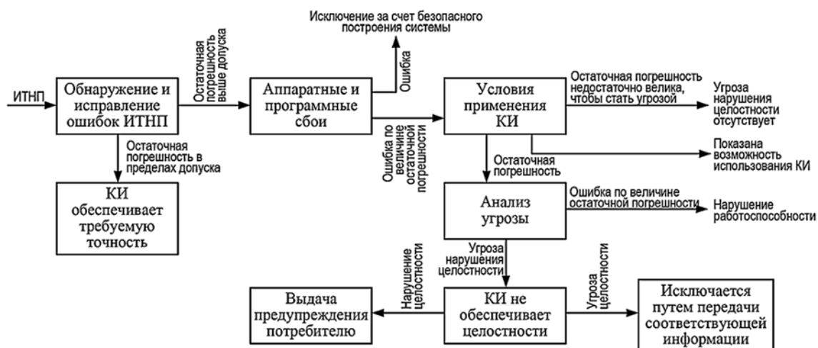
Рис. 2. Структурная схема алгоритма контроля целостности в SBAS
