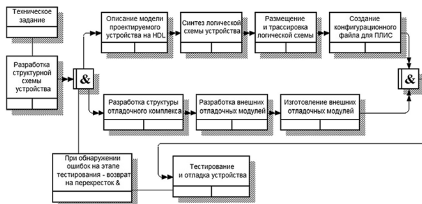
Рис. 6. Алгоритм проектирования устройства защищенного обмена информацией
