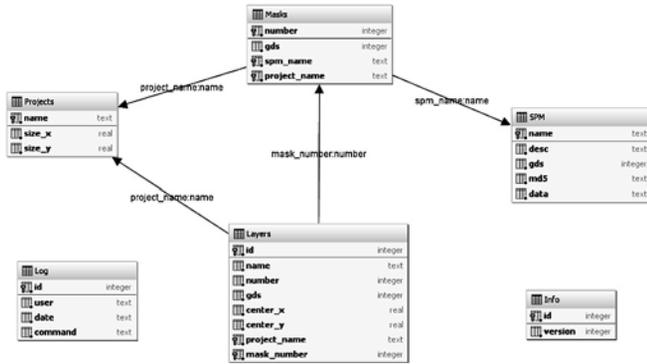
Рис. 3. Структура БД автоматизированной подготовки топологической информации для изготовления комплекта ФШ
