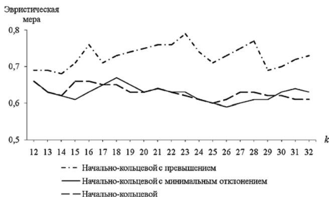
Рис. 10. Эвристические меры ресурсных оболочек полиномиальных кольцевых алгоритмов диспетчеризации массивами ресурсных квадратов
