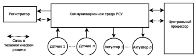
Рис. 6. Схема подключения регистратора к системе управления
