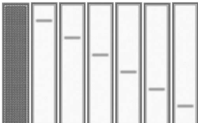
Рис. 2. Модельная область, расчетная сетка и фронт детонационной волны в виде движущегося источника теплоты (показаны его положения в различные моменты времени с постоянным шагом)
