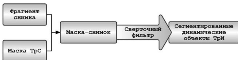
Рис. 4. Схема сегментации автотранспорта на космическом снимке
