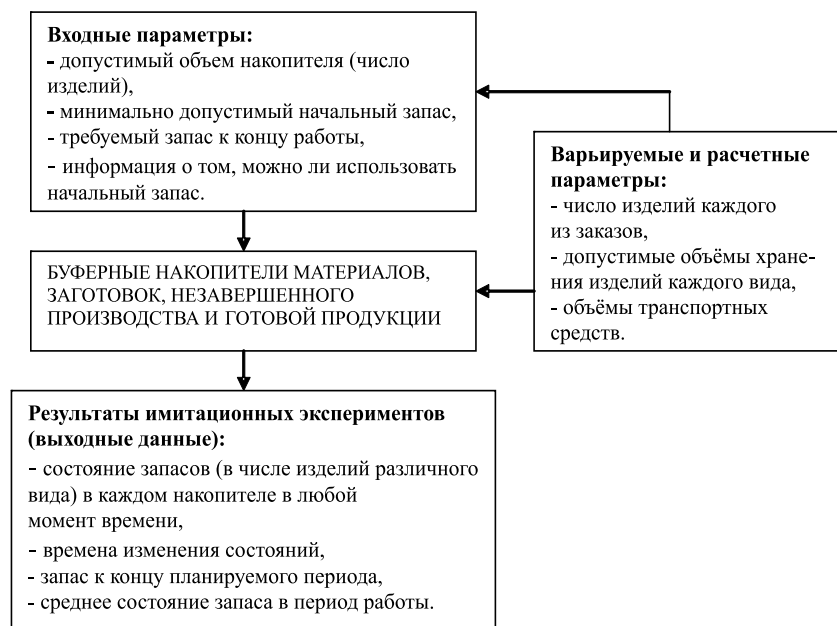
Рис. 4. Взаимосвязи входных, варьируемых и выходных параметров буферных накопителей производственной системы
