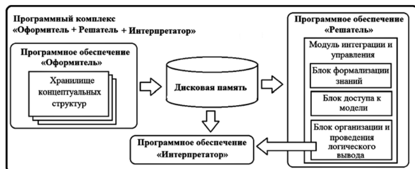
Рис. 9. Программный комплекс "Оформитель + Решатель + Интерпретатор"
