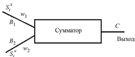
Рис. 1. Схема работы персептрона для размножения ( S_i^x , S_i^y — i -й ген хромосом с номерами x и y соответственно, подаваемый на входы B_1 и B_2 соответственно; w_1 , w_2 — веса входов)
