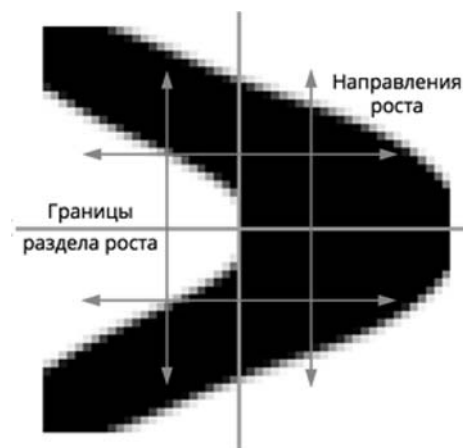
Рис. 6. Результат топологической оптимизации, полученный с помощью программы M-SIMP
