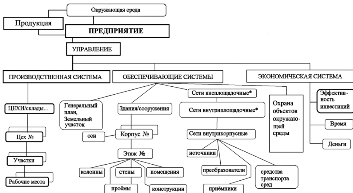
Рис. 2. Схема структуры данных информационной модели объекта проектирования (* — устроены как сети внутрикорпусные)
