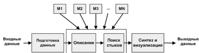
Рис. 1. Обобщенная схема технологии реконструкции: M1...MN — модули описания и сравнения характеристик фрагментов
