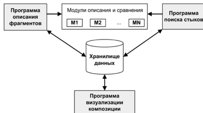
Рис. 2. Структура программного комплекса
