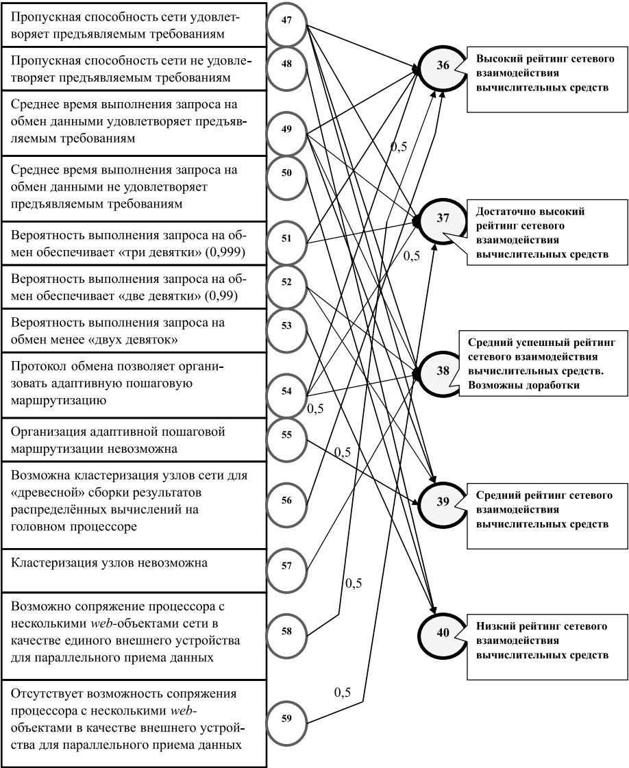
Рис. 3. Фрагмент логической нейронной сети для оценки качества сетевого взаимодействия вычислительных средств
