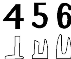
Рис. 2. Закон изменения проекции площади фигуры символа при проектировании ее на горизонтальную ось
