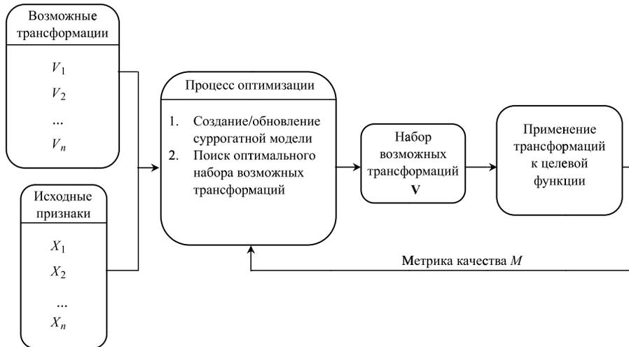
Рис. 2. Схема реализации метода автоматической генерации признаков
