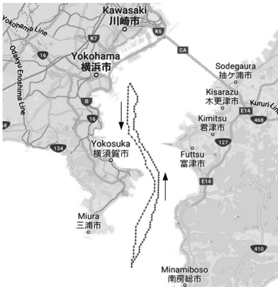
Рис. 3. Результаты планирования маршрута судна в Токийском заливе
