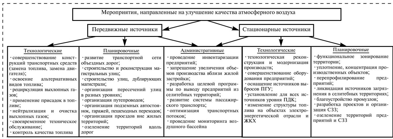
Рис. 13. Схема мероприятий, направленных на улучшение качества атмосферного воздуха
