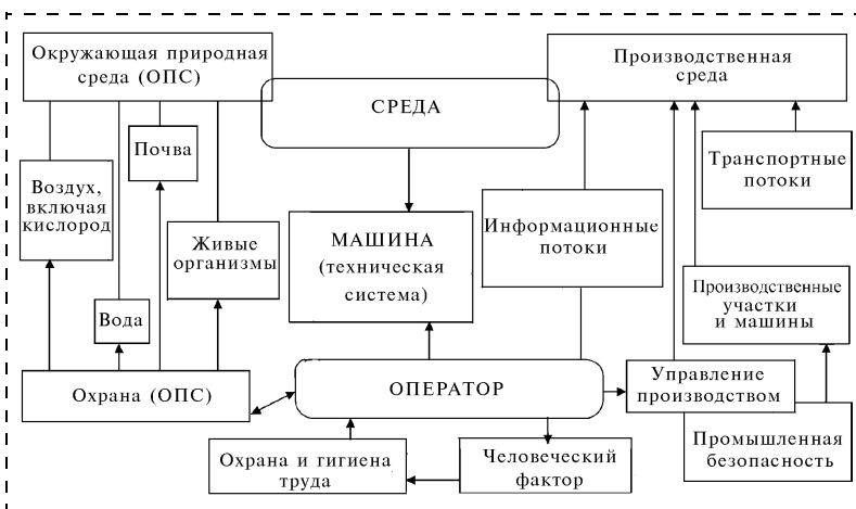
Рис. 1. Структурная схема системы "человек—машина—среда"
