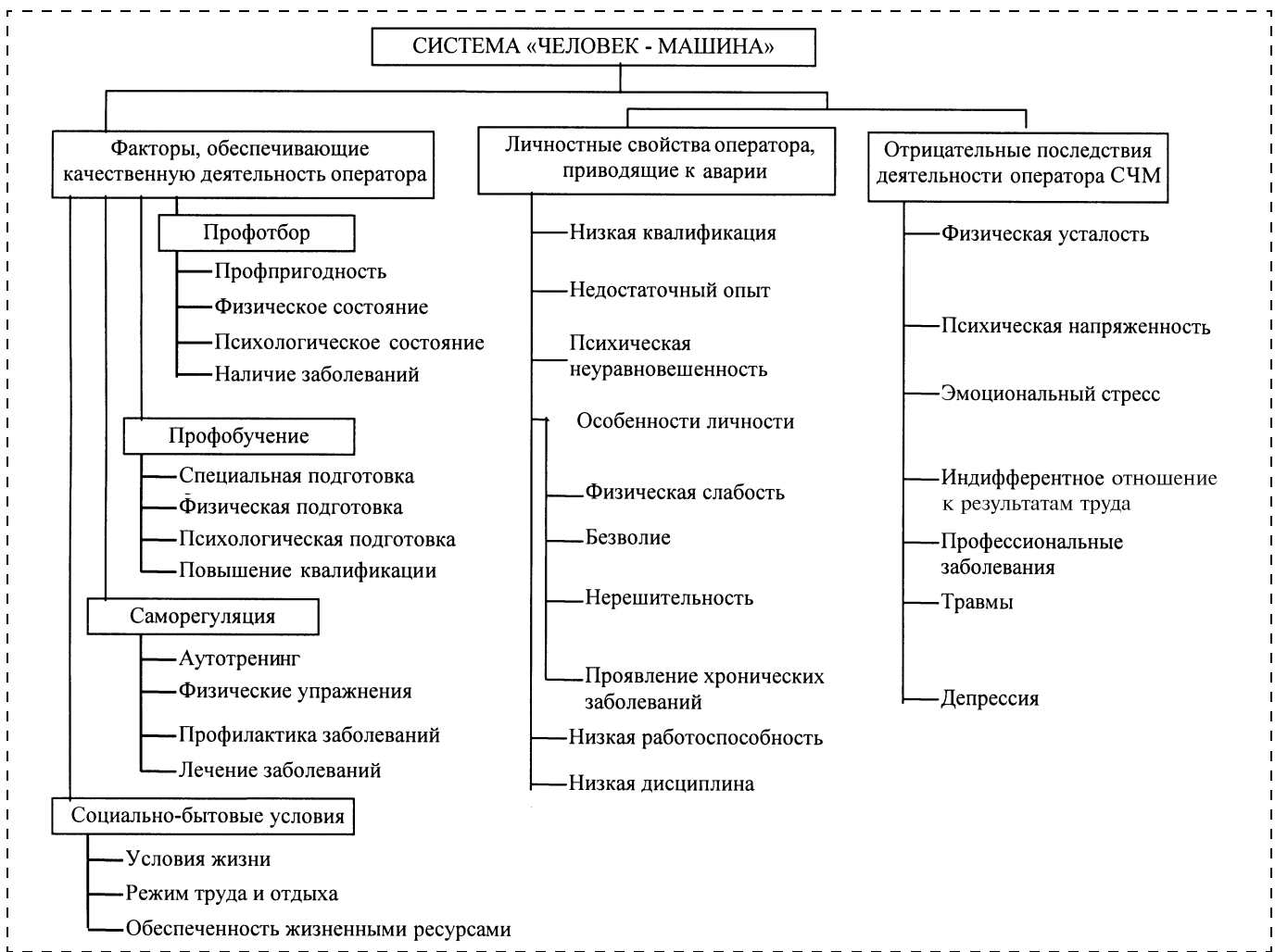
Рис. 5. Схема взаимосвязей системы "человек—машина"
