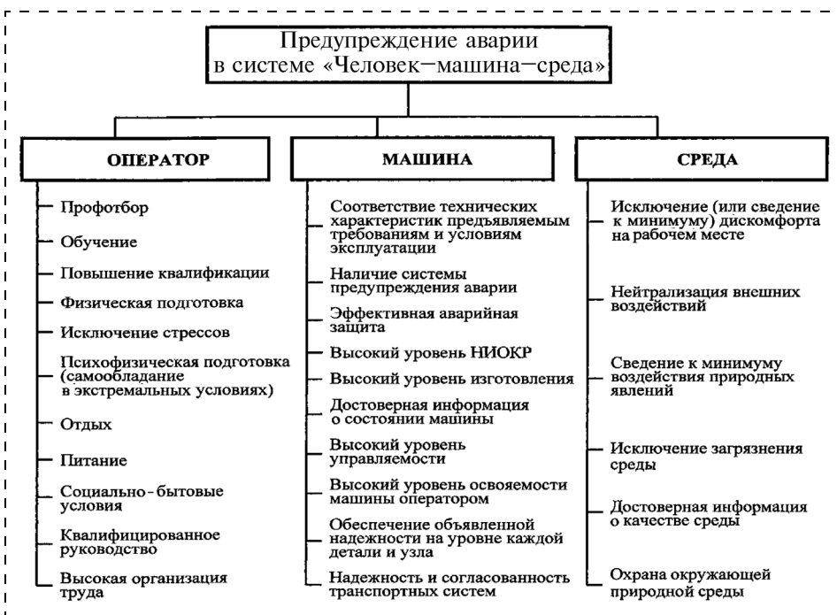
Рис. 8. Предупреждение аварии в системе "человек—машина—среда"
