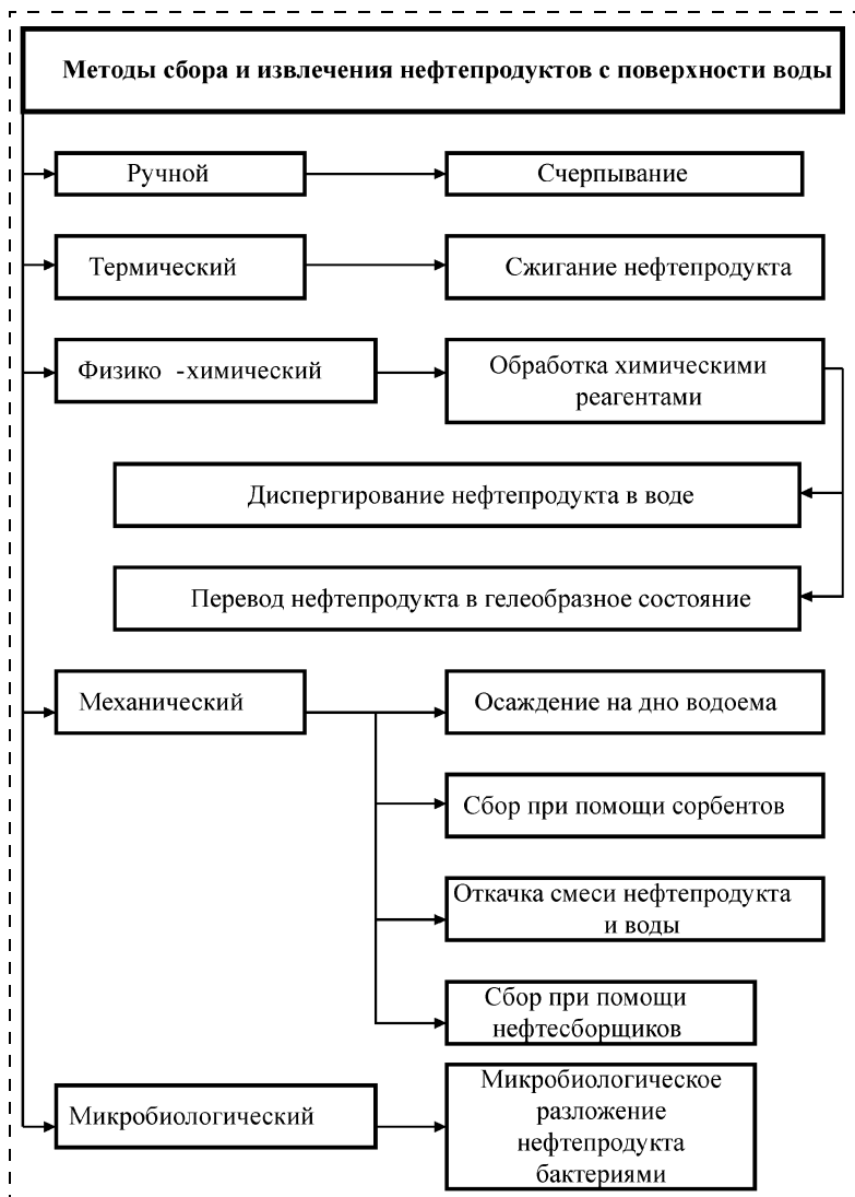
Рис. 1. Классификация методов сбора и извлечения нефтехимпродуктов с поверхности воды
