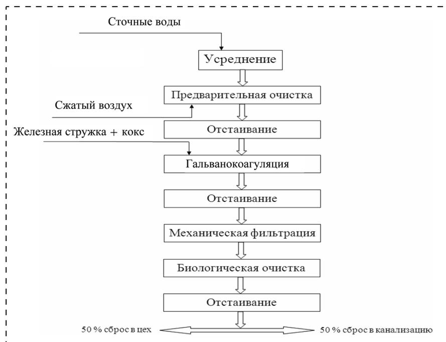
Рис. 4. Предлагаемая технологическая схема очистки сточных вод красильно-отделочного производства
