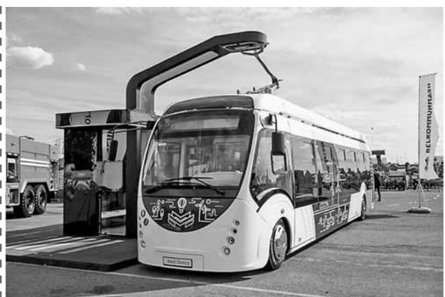
Электробус VitoVt производства Белкоммунмаш (Беларусь) с подключенным пантографом во время подзарядки батарей [12]
