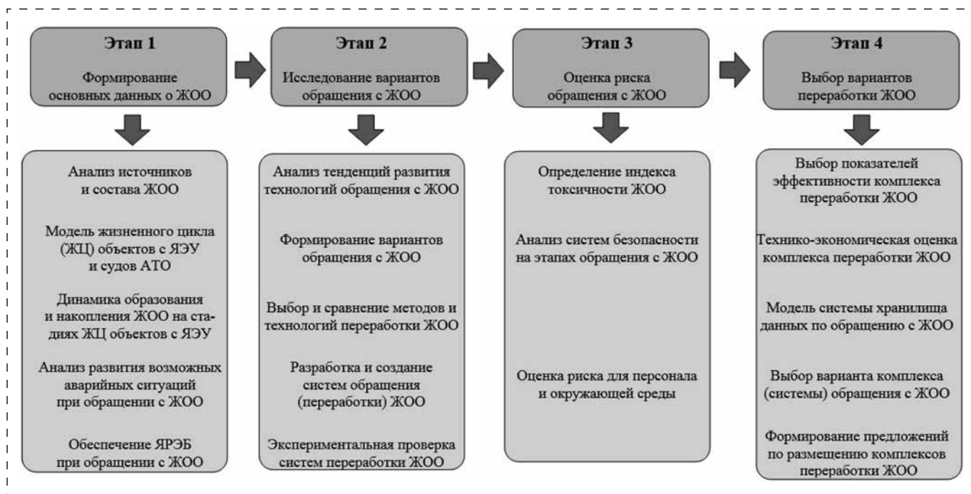
Рис. 2. Структура методики формирования комплекса переработки жидких опасных отходов, образующихся на стадиях жизненного цикла кораблей и судов с ЯЭУ
