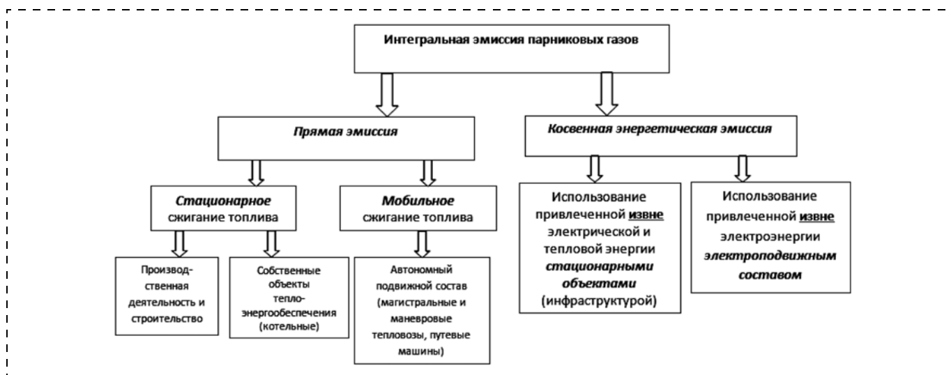
Рис. 1. Структура источников эмиссии парниковых газов на железнодорожном транспорте
