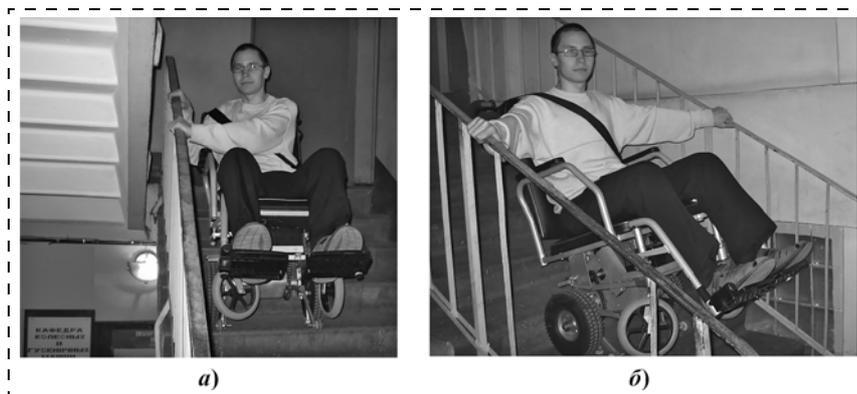
Рис. 2. Движение по лестнице на одном из ходовых макетов мобильного подъемника "Вектор-3" без ассистента, с использованием одного поручня (а) и двух поручней (б) лестницы
