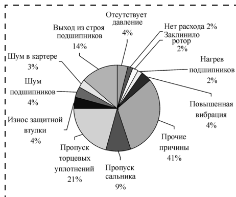
Рис. 1. Статистика отказов насосно-компрессорного оборудования на одном из нефтеперерабатывающих заводов г. Уфы
