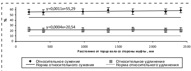
Рис. 10. Распределение экспериментальных значений относительного сужения и относительного удлинения по участкам вала
