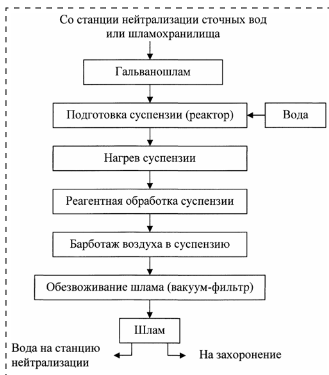
Рис. 2. Структурная технологическая схема процесса ферритизации
