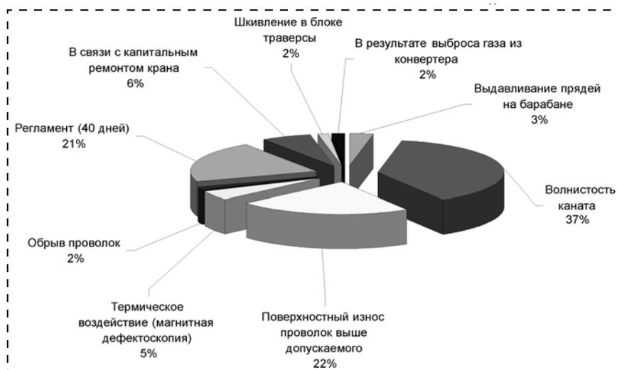
Рис. 2. Причины выхода из эксплуатации стального каната на литейных кранах конвертерного производства (период работы кранов 26.03.04—22.11.05)
