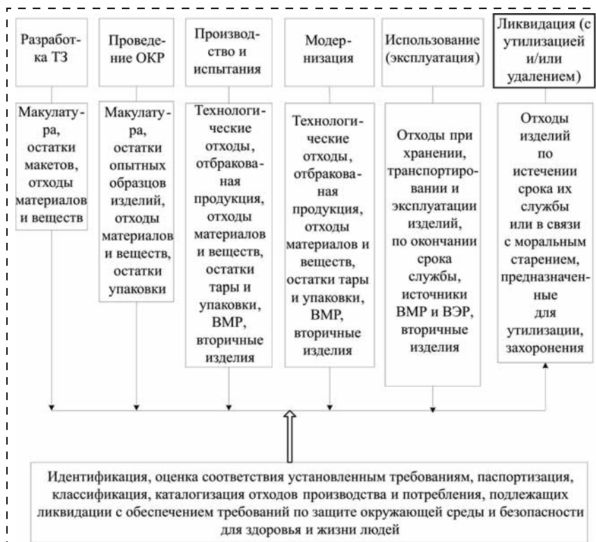
Схема образования на шести (из семи) стадиях жизненного цикла продукции (изделий) основных видов отходов, подлежащих ликвидации (ВМР — вторичные материальные ресурсы; ВЭР — вторичные энергетические ресурсы)
