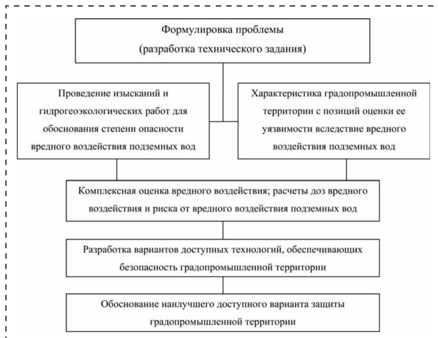
Рис. 3. Общая схема обоснования НДТ в градопромышленной гидрогеологии
