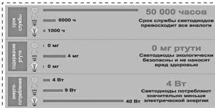
Рис. 2. Сравнительные характеристики светодиодных, энергосберегающих и ламп накаливания
